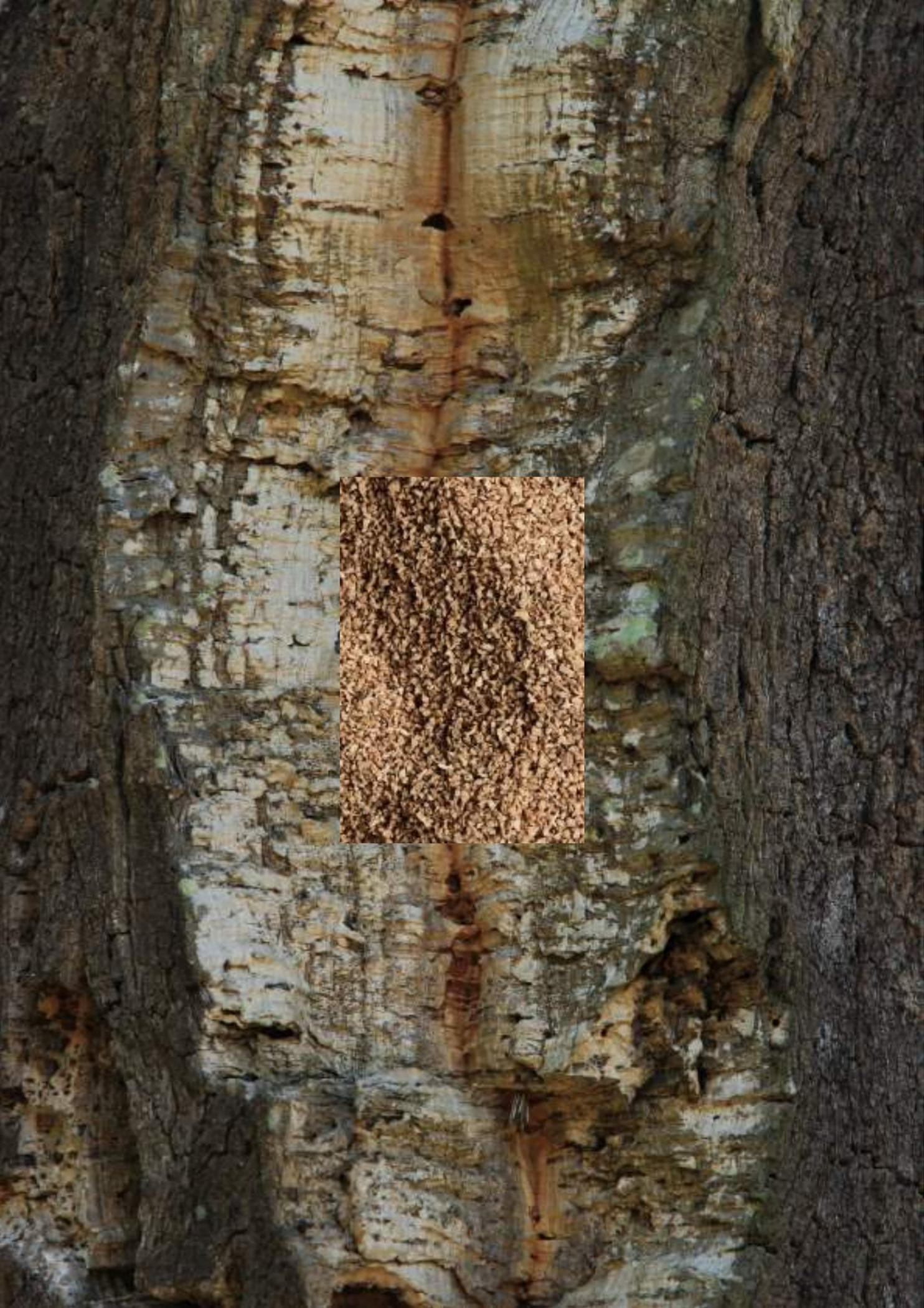
Le liège, matériau 100% naturel, renouvelable, biodégradable et entièrement recyclable, possède des propriétés uniques et inimitables : il est léger, élastique, résistant, hypoallergénique, retardateur de flammes, isolant thermique et phonique. De plus, il possède des caractéristiques sensorielles et émotionnelles remarquables : il est confortable, chaleureux et agréable au toucher.
