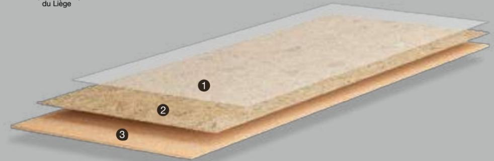
1 Protection CORKGUARD® à base d'eau avec la technologie CleanSurface 2 Revêtement en liège à texture rugueuse
